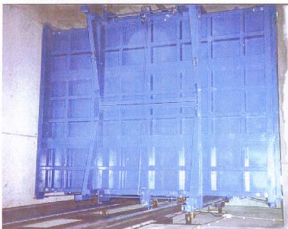
• Plataforma com dois pistões para 5000 kg.
