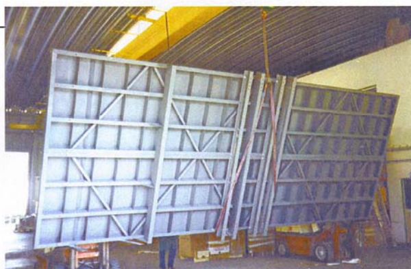
• Estrado de um monta-cargas para 10000 kg, com 7 x 3 m
