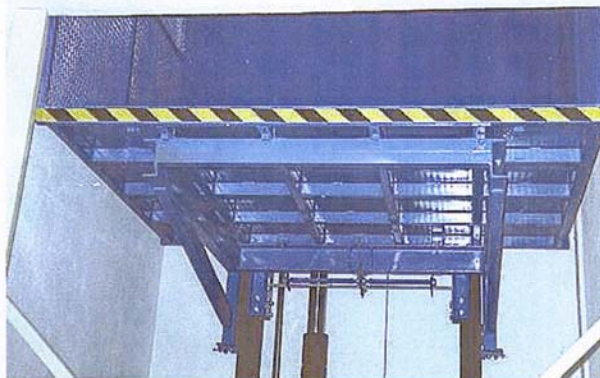
• Vista inferior do estrado de uma plataforma com capacidade para 2000 kg
